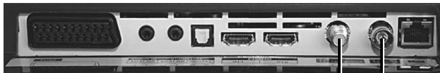
DVB-S2 DVB-CT Antennenanschluss
